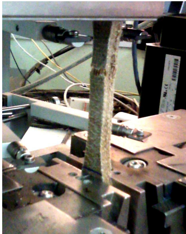
Fig. IV.13. L'essai de traction sur éprouvette
