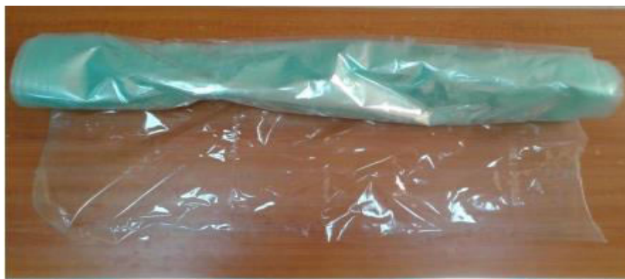
Fig. IV.1. Film de plastique en polypropylène (PP) recyclé
