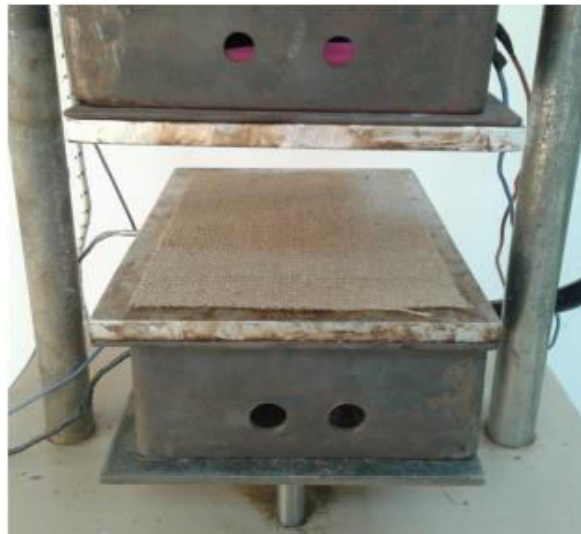
Fig. IV.6. Représenté la compression des tissus de Jute
