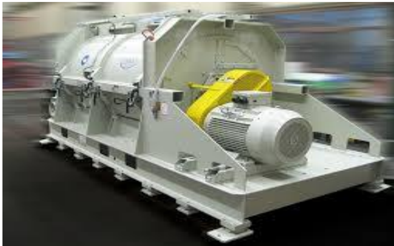
Figure. II.9: Sécheur thermique et mécanique pour tous plastiques
