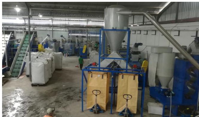
Figure. II.8 : Lavage des paillettes plastiques
