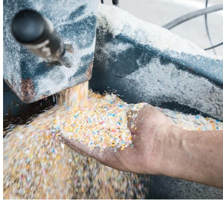
Figure. II.7 : Broyage des déchets plastiques
