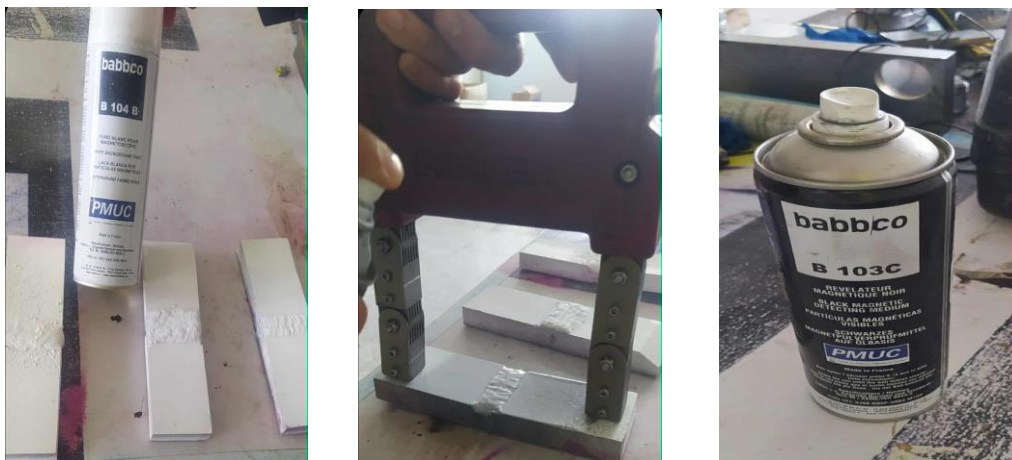
Figure 42 : Procédé de contrôle par magnétoscopie
