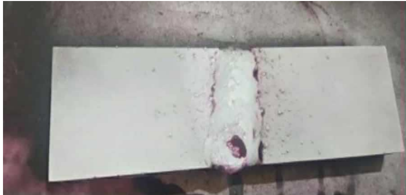
Figure 40 : les défauts détectés dans la pièce après ressuage.
