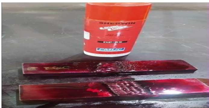
Figure 38 : Application du produit ressuage Rouge.
