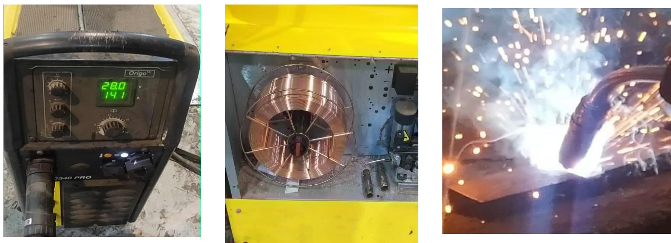
Figure 35 : Équipement et procédé de soudage MIG/MAG
