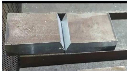
Figure 33 : réalisé par fraisage un chanfrein à 30°
