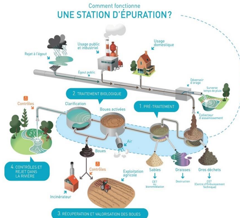
Figure II-7 : Le processus de fonctionnement d'une-station-d'épuration
