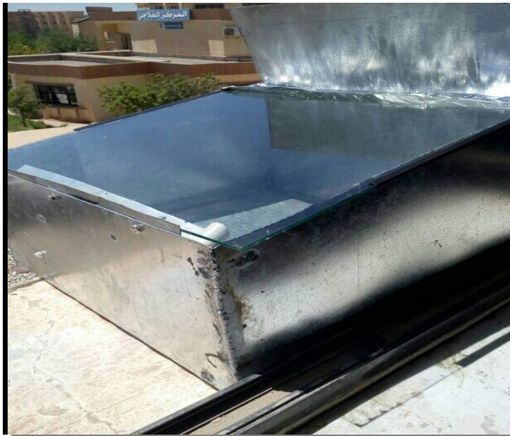
Figure IV.1 : Image photographique du capteur solaire
