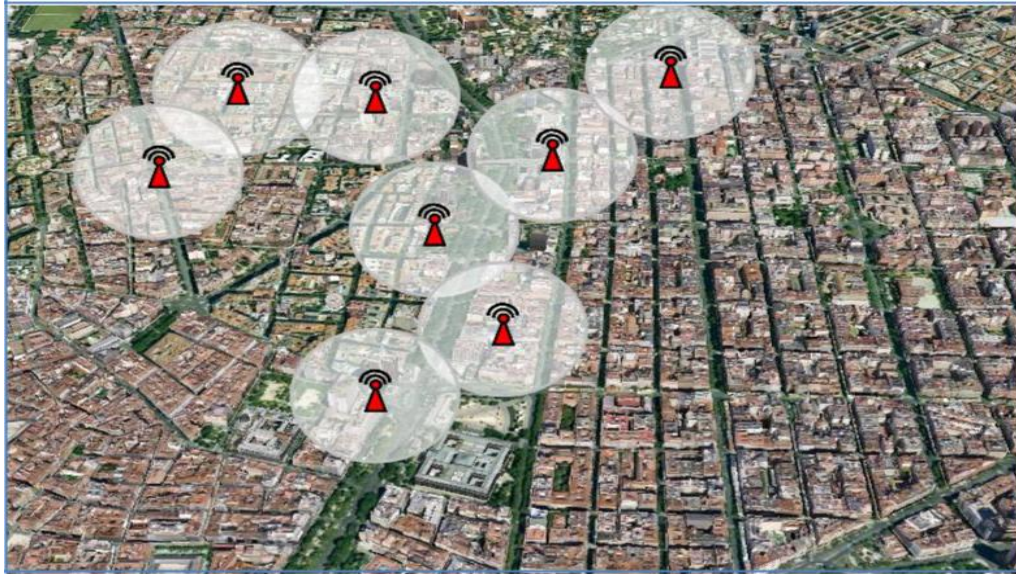
Figure (2.1): Exemple de 8 RSUs déployées suivant la politique du déploiement des coûts minimum .
