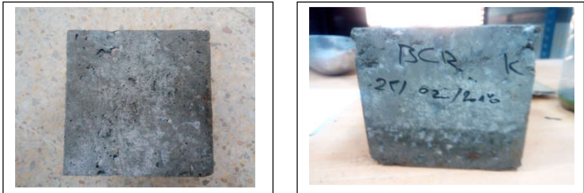
Figure III.2. éprouvettes de forme cubiques 10 x 10 x 10 cm en BCR.
