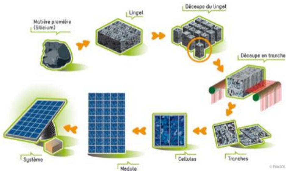
Figure III-1 : La chaîne de fabrication des modules photovoltaïques [22]
