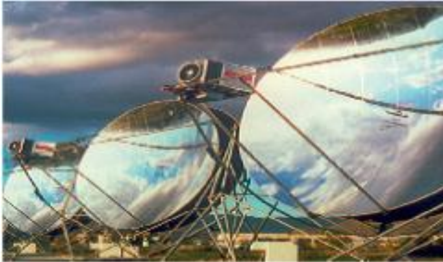
Figure II.12 : Exemple de concentrateur parabolique
