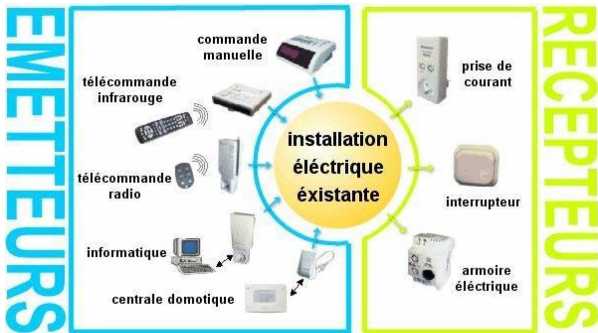
Figure 1.4. Exemple d'installation domotique avec la technologie CPL
