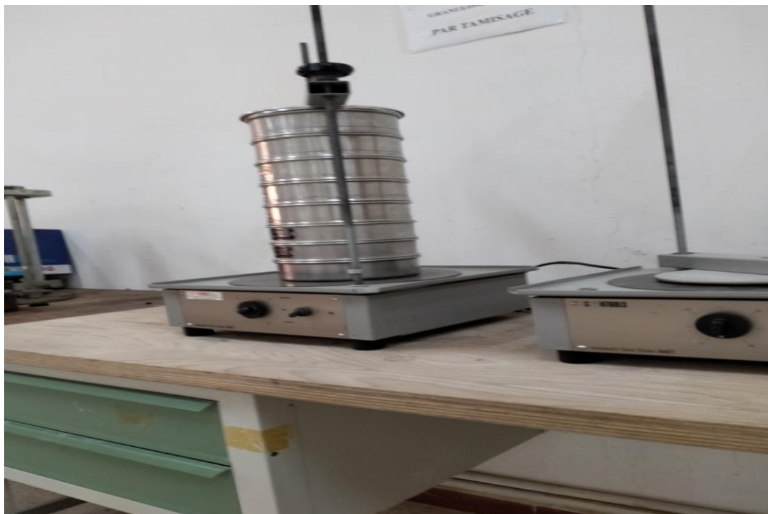
Figure 22 : Machine à tamiser électrique de laboratoire de Génie Mécanique du type :KERN
