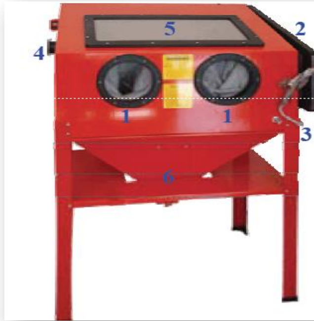
figure 13 :Cabine de sablage Désignation
