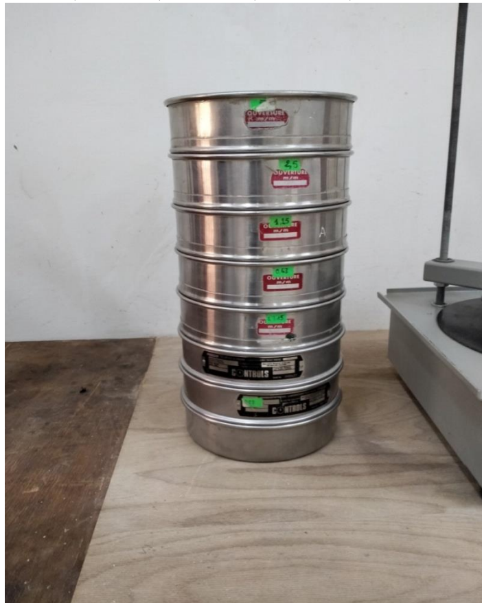
Figure 23 : Colonne de tamis avec des mailles respectivement de haut en bas : 5mm ;2.5mm ;1.25mm ;0.63mm ;0.315mm ;0.160 mm;0.08mm.
