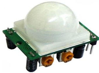
Figure III.6: Image réelle du capteur de mouvement PIR.
