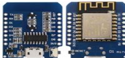
Figure III.10: Image réelle du module Wifi ESP8266 – ESP-D1.
