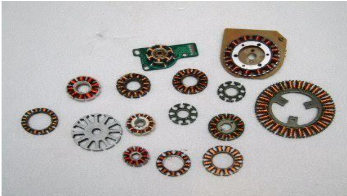
Figure I.8 : Bobinages de différents moteurs
