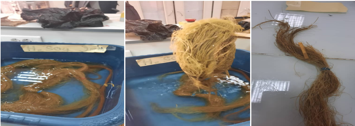
Figure. IV. 34:traitement d'alfa par H 2 SO 4 pour éliminer les traces de NaOH.
