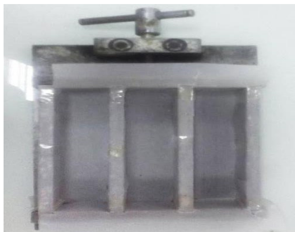
Figure. IV. 36:moule utilisé pour éprouvettes lisses de BP
