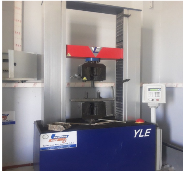
Figure. IV. 39:Essai de FTR (YT testage Machines/20KN).
