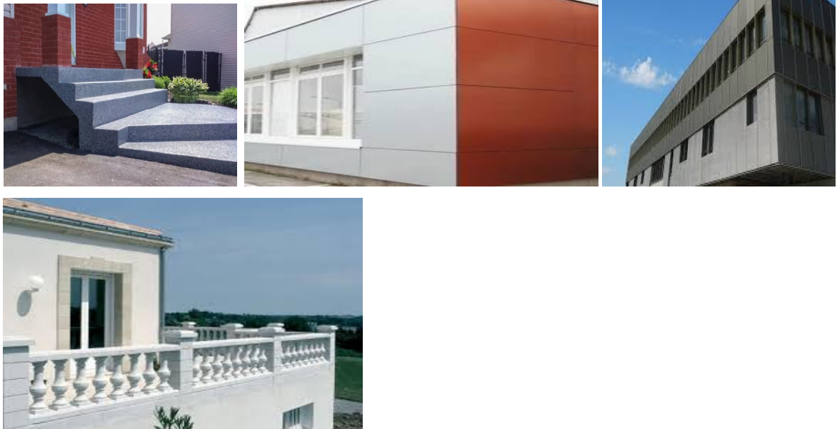
Figure. I.3:Façades et marches d'escalier en béton polymère.
