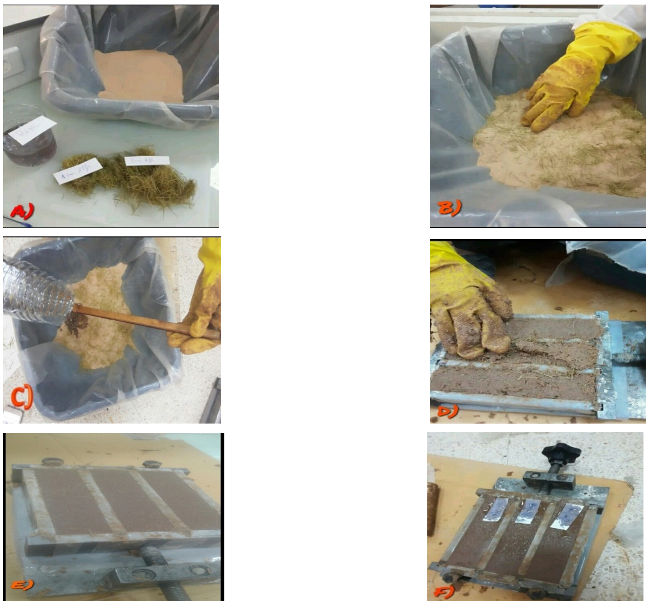
Figure. IV. 37: Etapes de moulage de béton polymère par contact.
