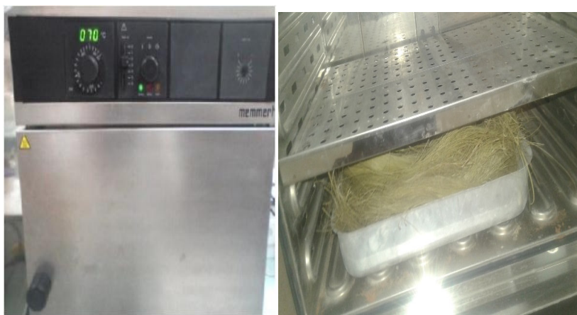
Figure. IV. 32: Etuve de séchage à 70°C.
