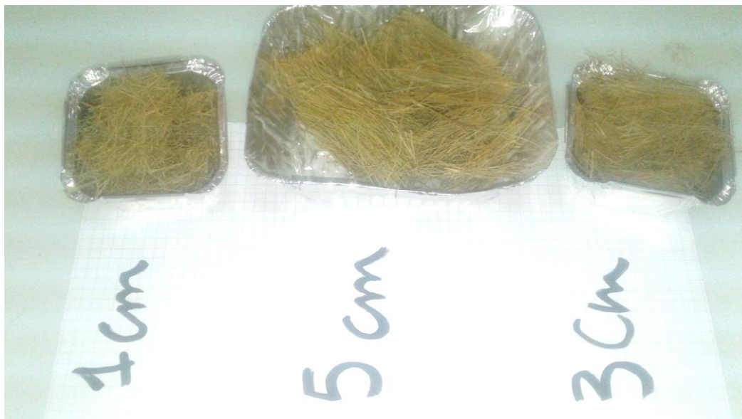
Figure .IV.35:la fibre alfa découpées en différentes (1cm ,3cm et5cm).
