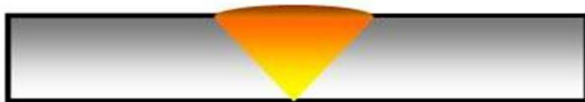
Fig.III.9 Cordon en court-circuit.
