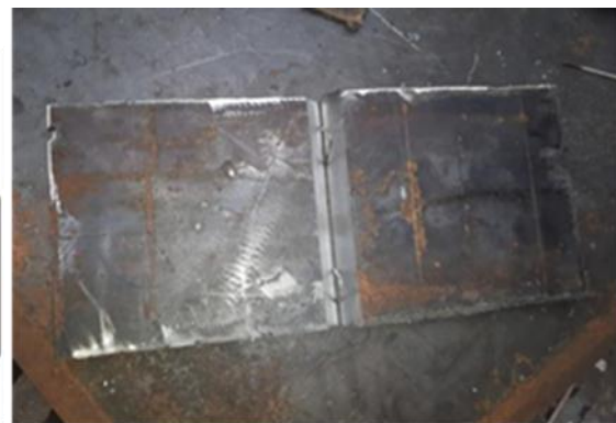
Fig.IV.6 Réalisé par fraisage un chanfrein à 30°.
