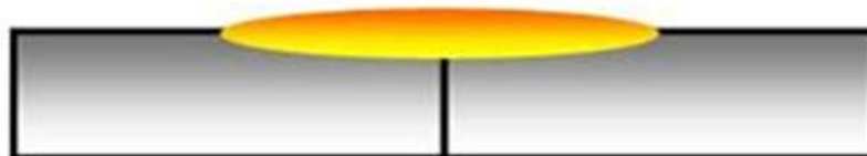
Fig.III.13 Cordon en pulvérisation axiale.
