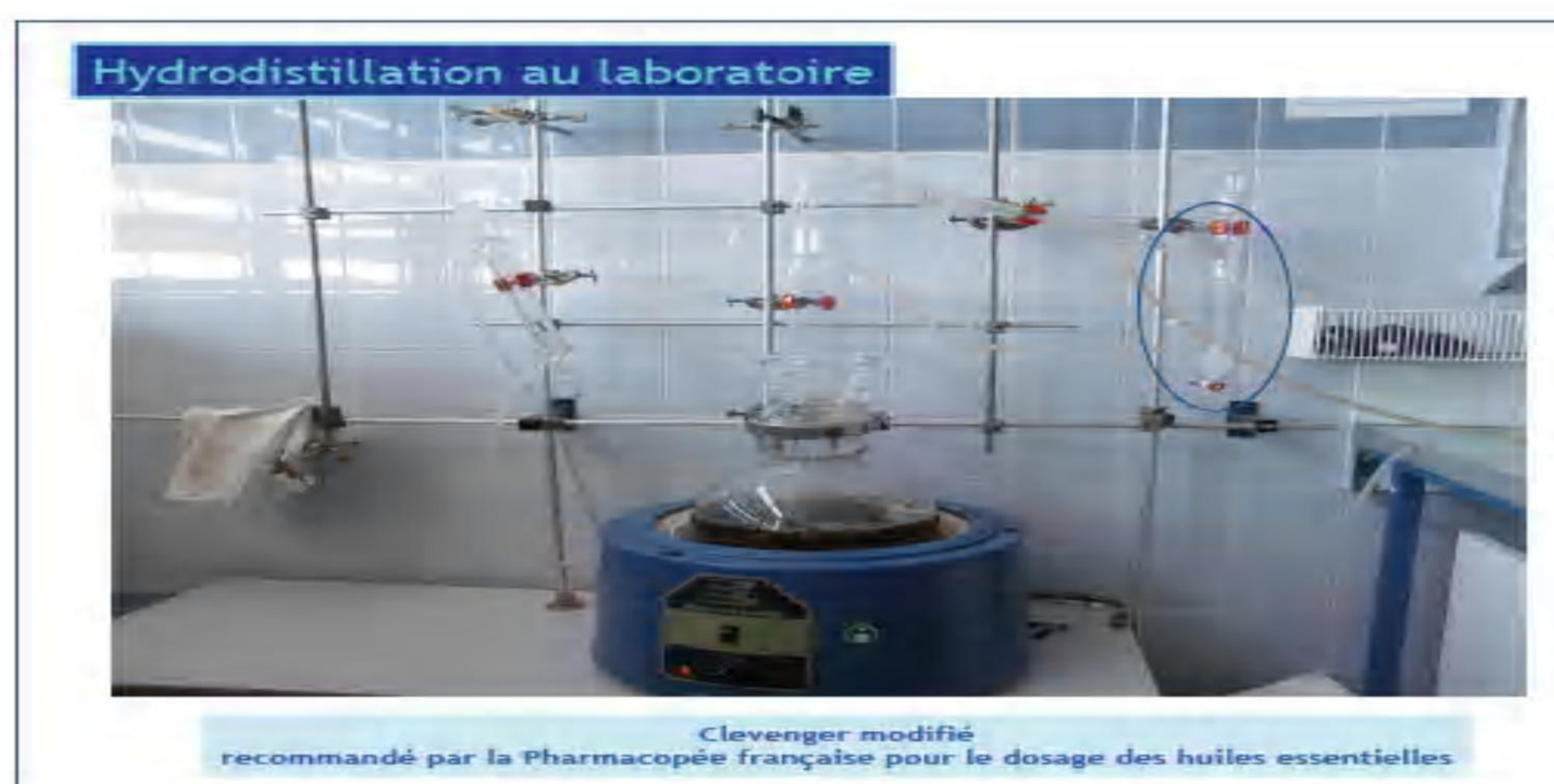
Figure 04 : Schéma de principe d'une extraction par hydrodistillation au laboratoire
