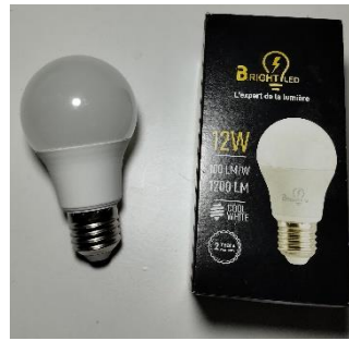
Figure V.10 : Lampe LED blanc froid de 12W. (Photographie personnelle)
