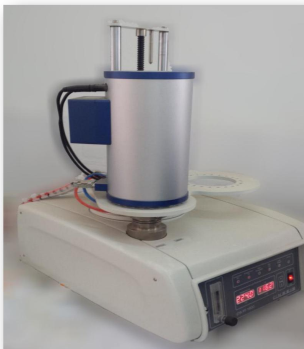
Figure II.2 : Appareil ATD-ATG de marque LINSEIS 1600
