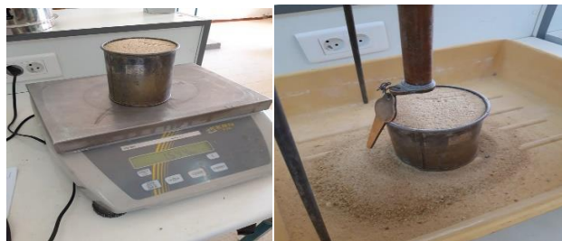
Figure II.5 : Essai La masse volumique apparente de sable au laboratoire.
