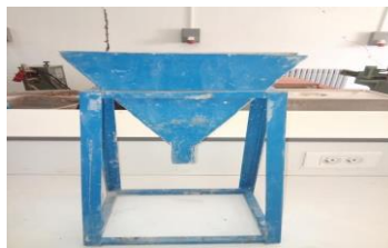
Figure I.5 : Déroulement de l'essai v (v-funnel).
