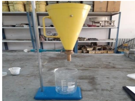
Figure II.7 : Taux de saturation par Super plastifiant. (Conne de March).
