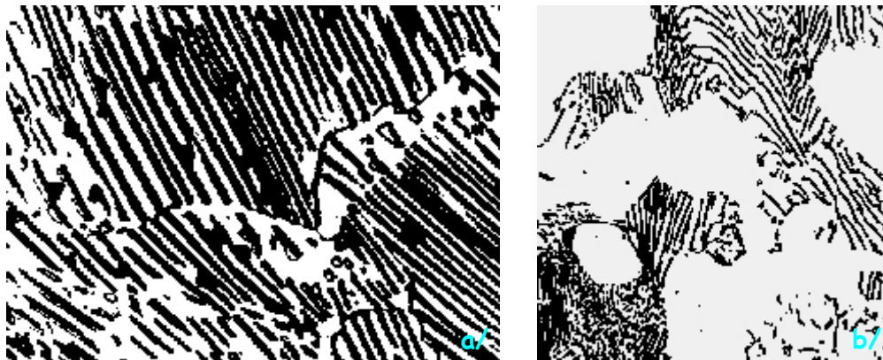
Fig. (I-5) : structure perlitique: a/ dans un acier eutectoïde et b/ dans un acier de 0.3% de carbone. [4]
