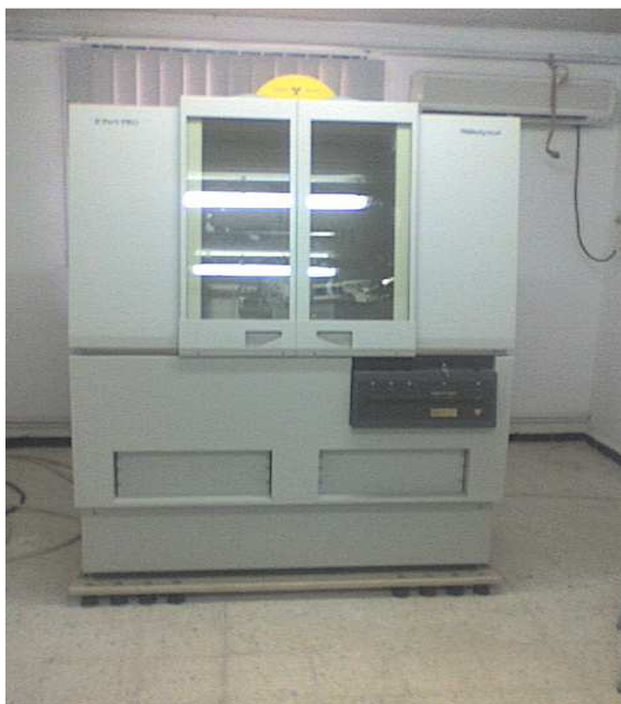
Figure (III-4) : Photographie de diffractomètre utilisé.
