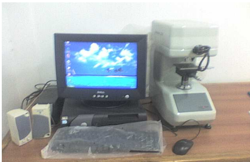
Figure (III-6) : Photographie de microduromètre utilisé.
