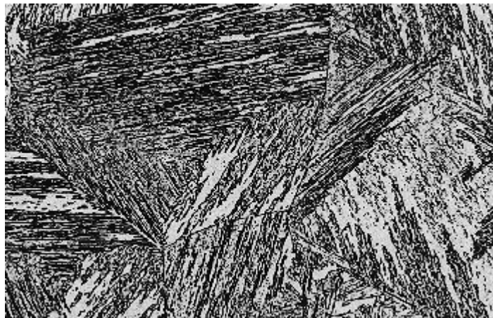
Fig. (I-6) : micrographie de la martensite. [4]
