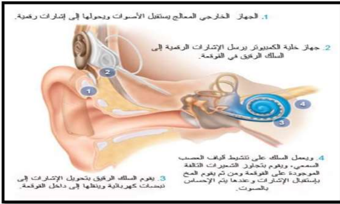
الشكل رقم (4): يوضح آلية عمل جهاز الزرع القوقعي.
