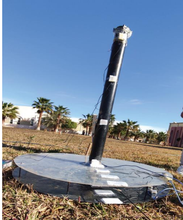
Figure 34 : position des sondes sur le prototype expérimentale 2[59]
