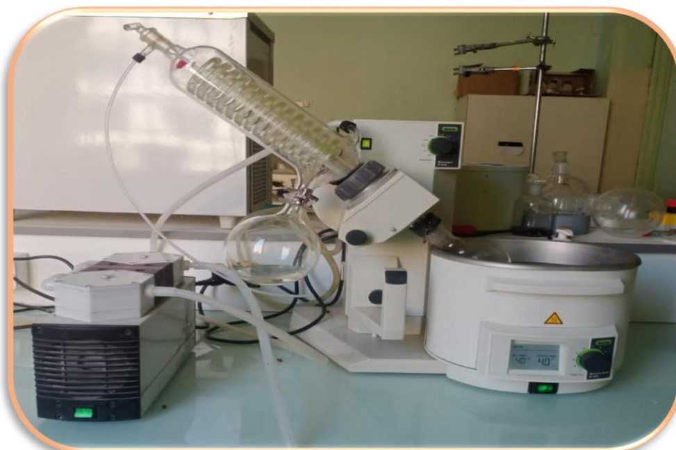
Figure:Appareil du rotavapeur rotatif .
