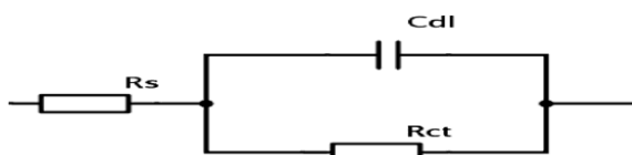
Figure I.12. Circuit électrique équivalent d'un système électrochimique (Circuit de Randles).
