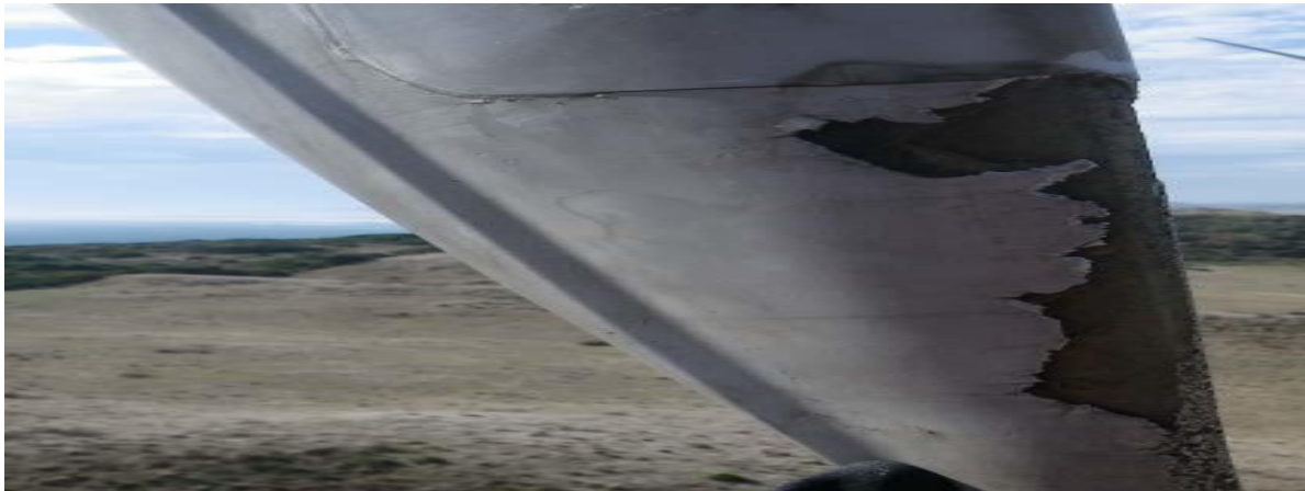
Fig. III.2. Érosion du bord d'attaque
