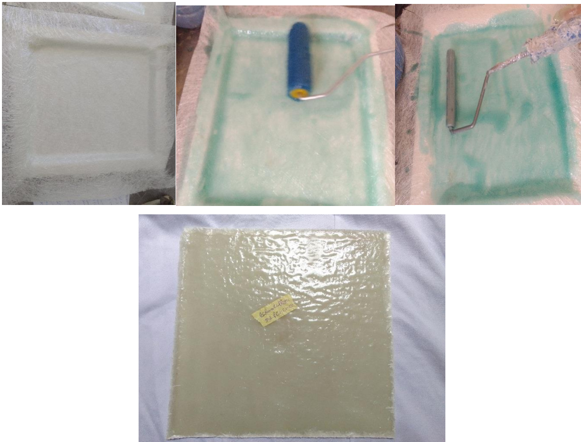
Figure 35: Les étapes de préparation d'échantillon référent
