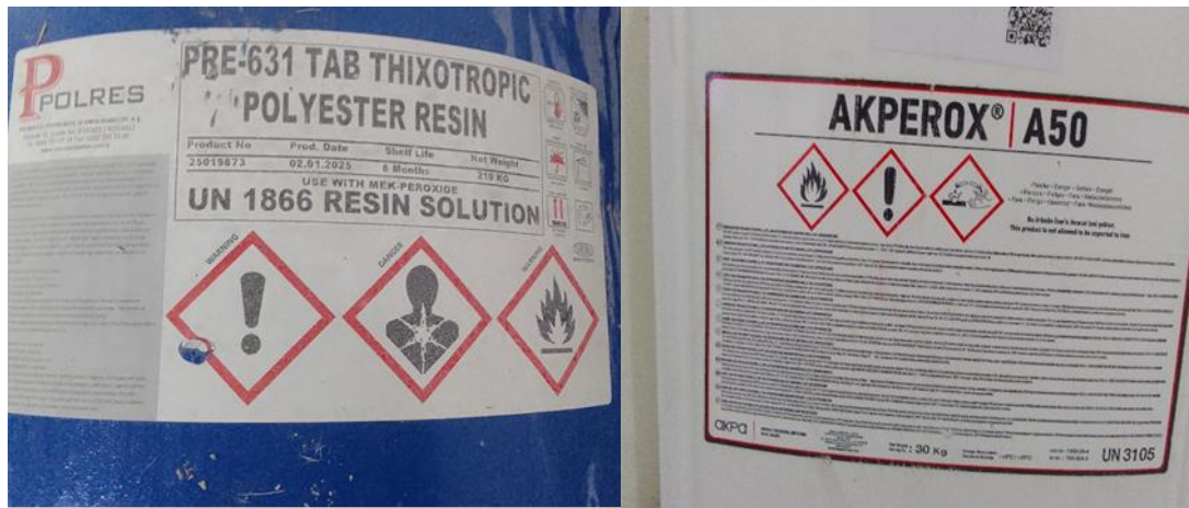
Figure 31 : Résine polyester et le durcisseur
