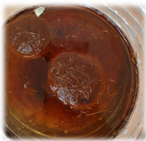
Figure 28 : Traitement des fibres avec une solution de NaOH à 5 h à différents concentrations
