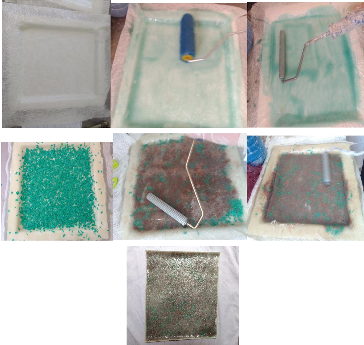
Figure 37: Les étapes préparation des échantillons de déchets plastique avec les fibres végétales
