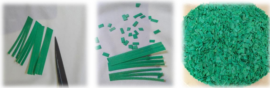
Figure 25: Préparation de feuillard plastique
