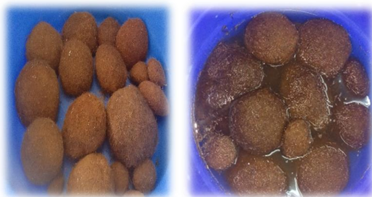
Figure 28 : Traitement des fibres avec une solution de NaOH à 5 h à différents concentrations
