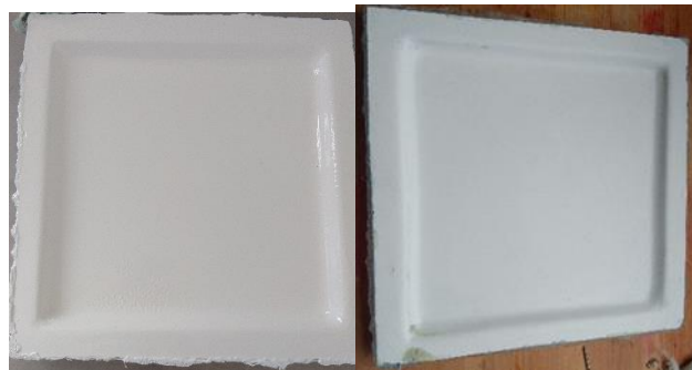
Figure 33: Le moule utilisée pour préparer les échantillons
