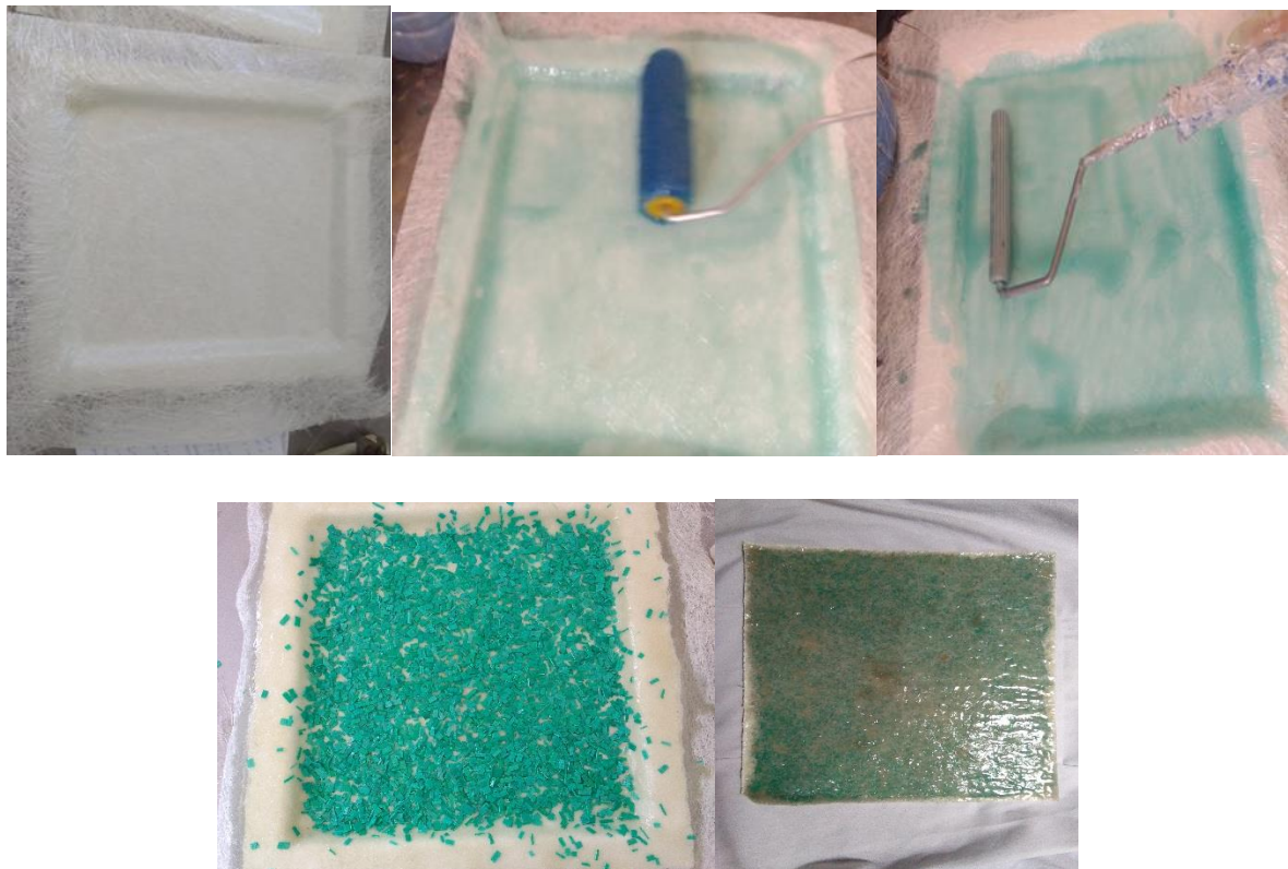
Figure 36: Les étapes de préparation des échantillons de déchets plastique
