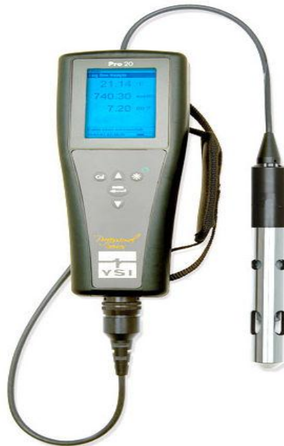
Figure (II.2) : dispositif de mesure d'Oxygène dissous
