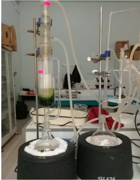
Figure 05 : Système d'extraction (photo original, 2018).
