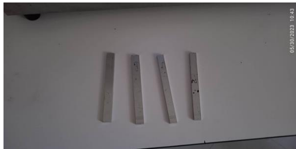
Figure V.8. Les éprouvettes d'alliage d'aluminium 7075t6 pour l'essai de traction.
