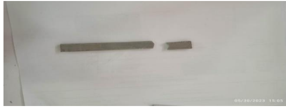
Figure V.13. Éprouvette 3 après l'essai de traction.
