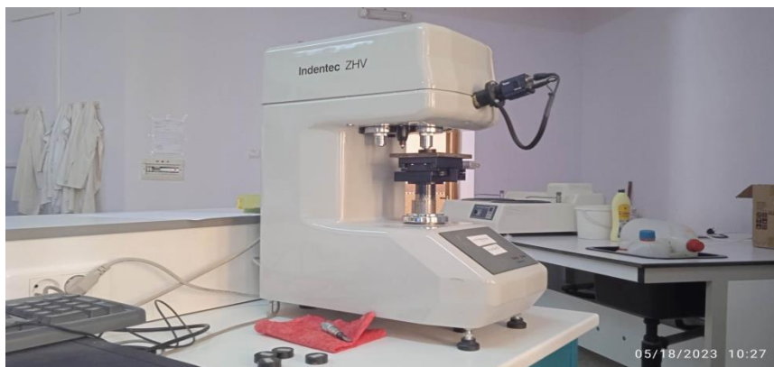
Figure III.14. Micro duromètre utilisé.
