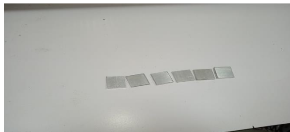
Figure III. 3. Les chantillons de l'alliage 7075t6
