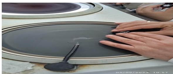
Figure III.9. Opération de Pré-polissage.
