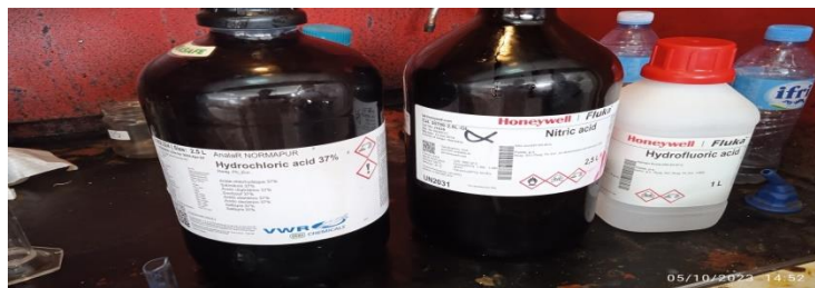
Figure III.11. Réactif d'attaque chimique utilisé (solution Keller).
