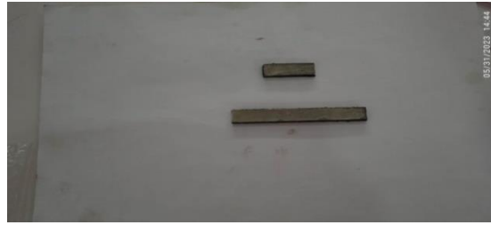
Figure V.15. Éprouvette 4 après l'essai de traction.
