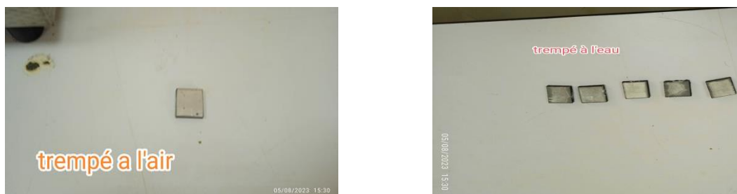
Figure III. 5. L'échantillons après trempe
