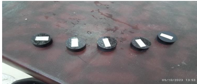
Figure III. 7. Les échantillons après l'enrobage
