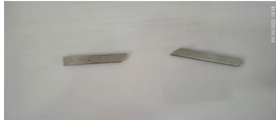
Figure V.11. Éprouvette 2 après l'essai de traction
