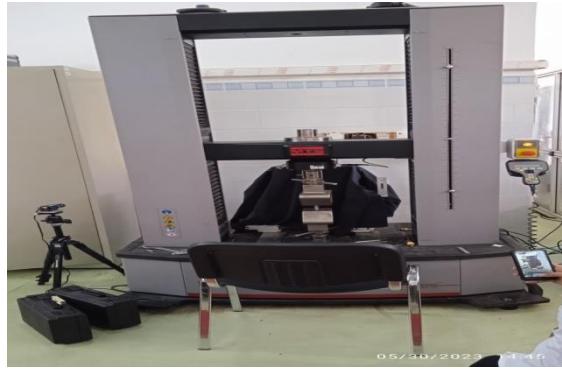
Figure III.15. Machine utilisée pour la traction.
