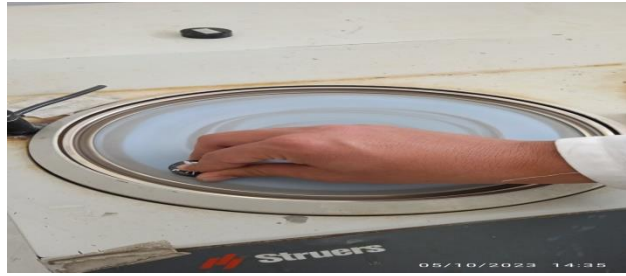
Figure III.10. Opération de polissage de finition
