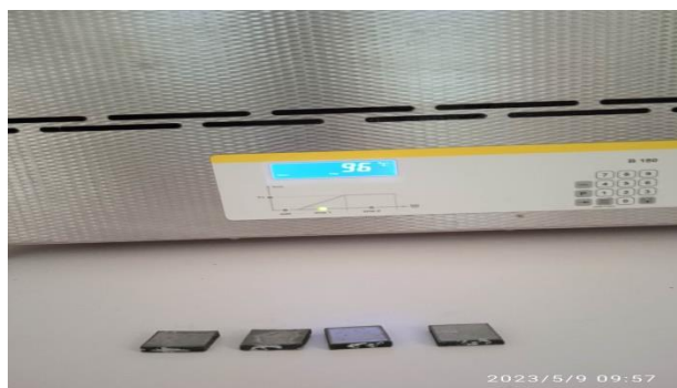
Figure III. 6. Les 4 Échantillons après revenu.
