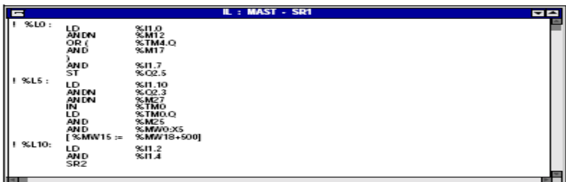
Figure IV.5 : exemple de programme en langage liste d'instructions .
