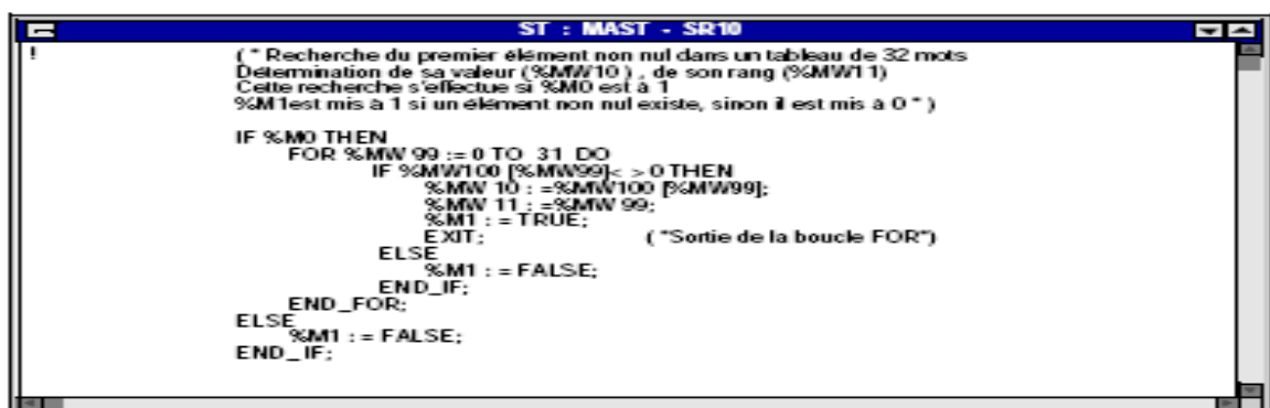
Figure IV.6 : exemple de programme en langage littéral structuré .
