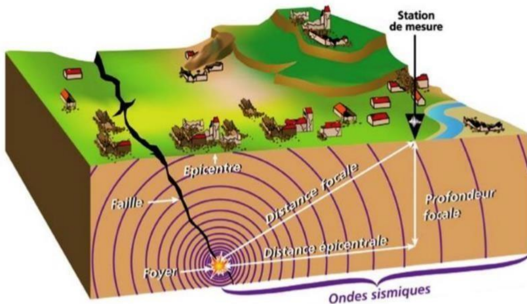
Figure I.2 Épicentre et foyer d'un séisme, l'importance des dommages diminue avec la distance à l'épicentre.
