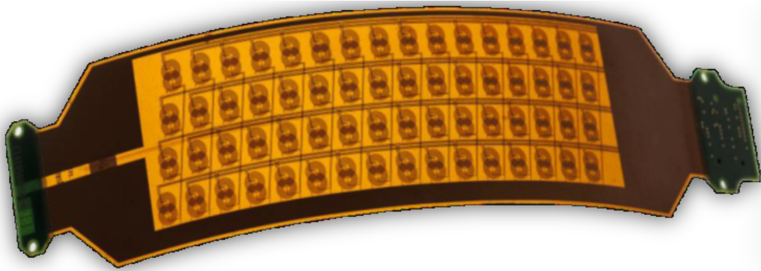
FIGURE 1.13 – Capteur multiéléments composé de bobines gravées sur film Kapton
