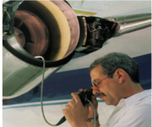
b) Inspection du réacteur d'un avion
