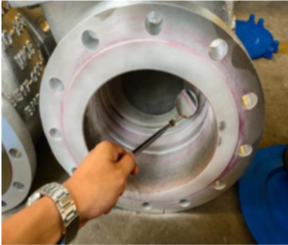
a) Miroir d'inspection
