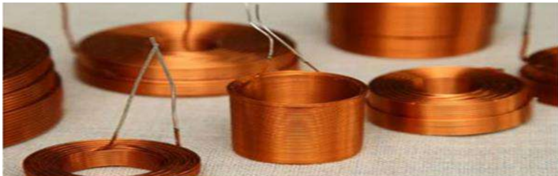
FIGURE 1.12 – Bobine construite par l'enroulement d'un fil de cuivre
