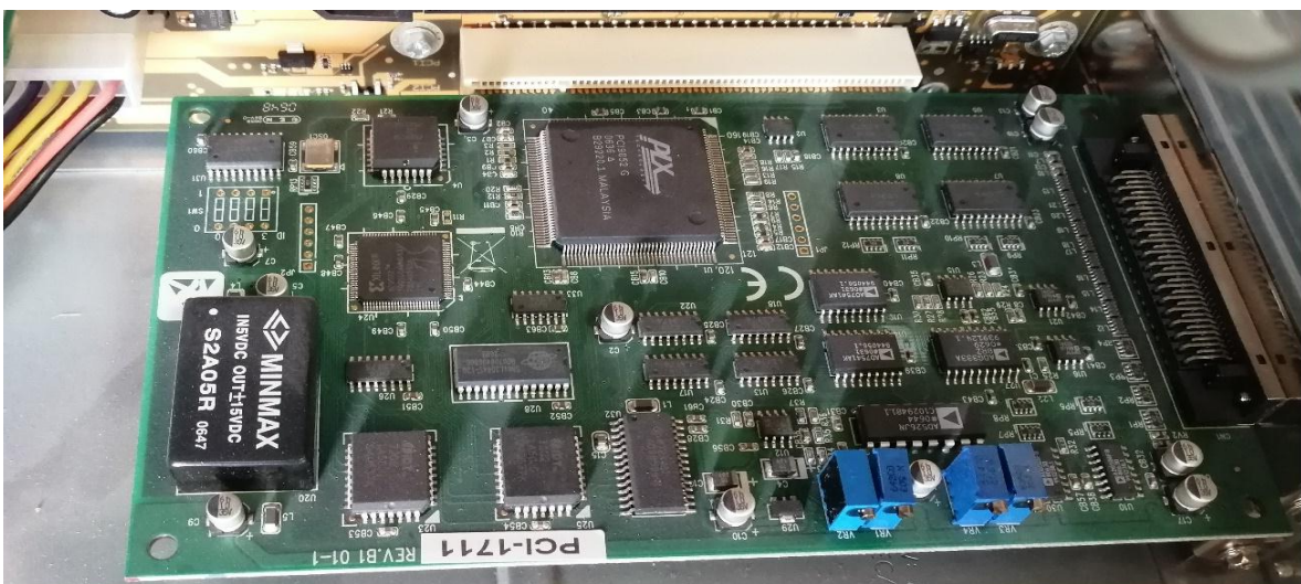
Figure I.6 : Photo réel d'une carte d'acquisition PCI-1711.
