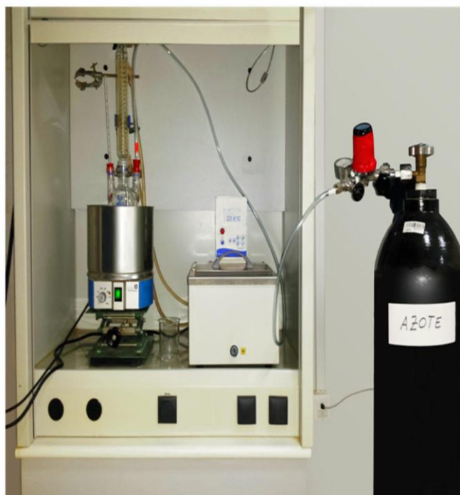
Figure II.5: Montage de la manipulation de polymérisation du styrène sur la Mt-Al 13 .
