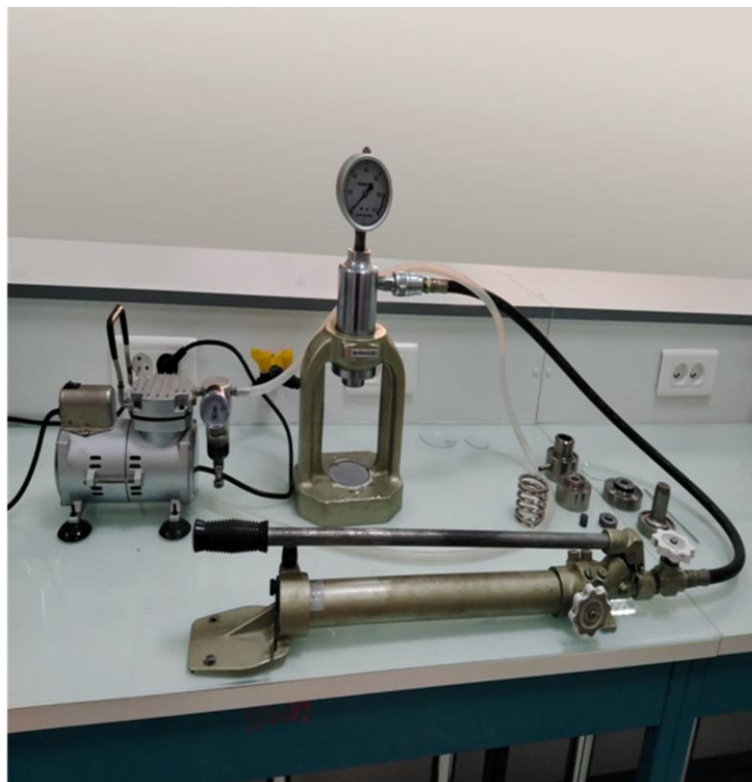
Figure II.7: Presse pour préparation de pastille KBr.
