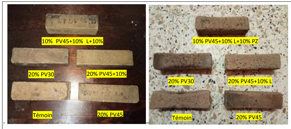
Figure IV.28 : éprouvettes de mortier après 7j (à gauche) et 28 j (à droite) d'immersion dans 5% HCl
