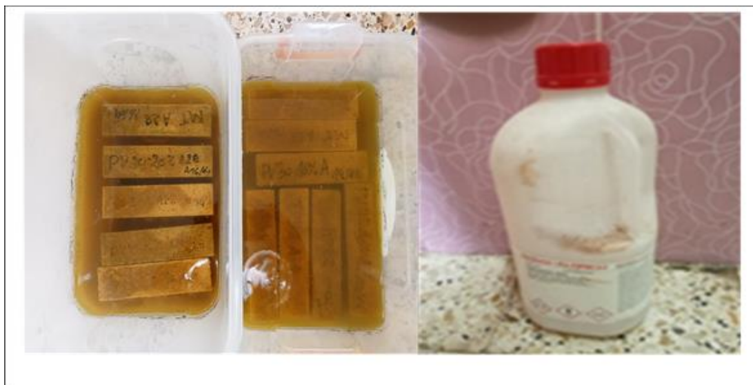
Fig. III.9 : éprouvettes prismatiques immergées dans une solution de 5% HCl
