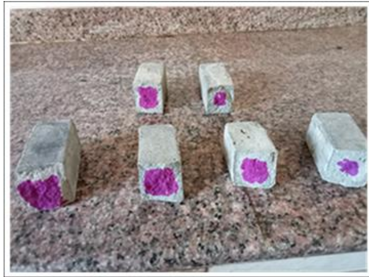
Figure IV.31 : Eprouvettes de mortiers après 28 jours de carbonatation
