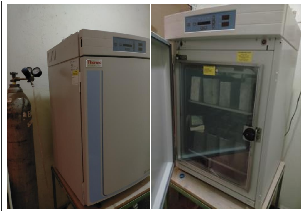
Fig. III.8 : photographie de l'enceinte de carbonatation accélérée montée au laboratoire de l'université de Laghouat.
