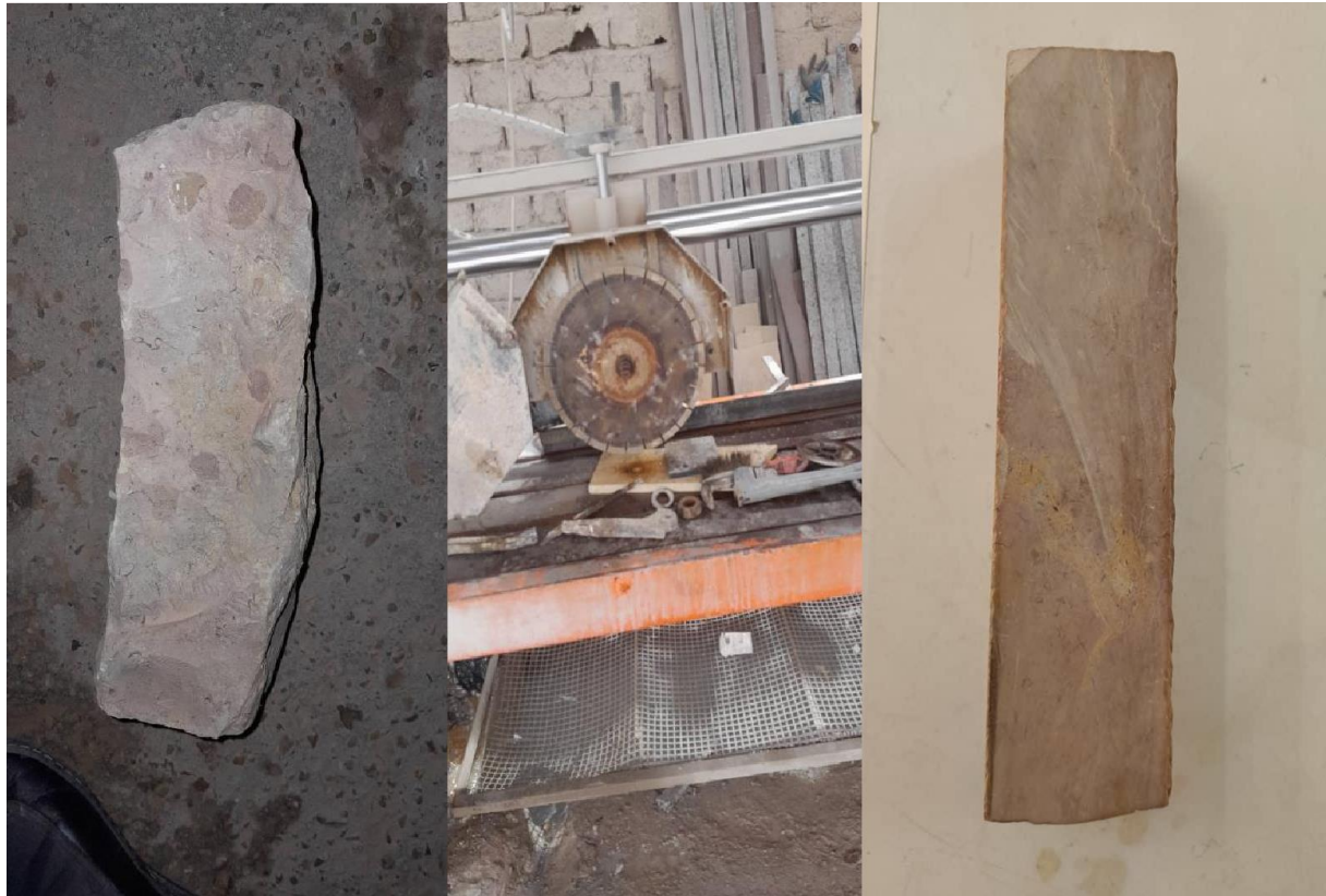
Fig (II.9) : Étapes de fabrication des échantillons « AL ALEG ».
