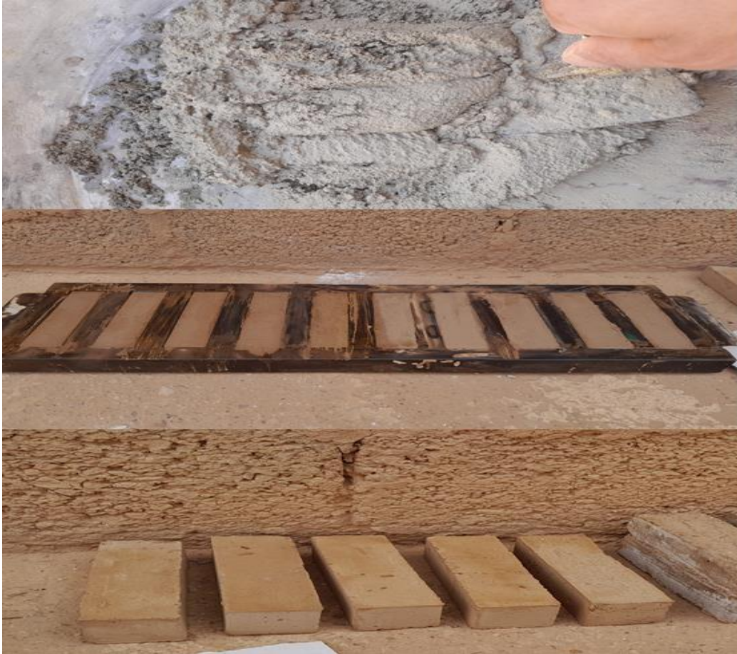
Fig (II.7) : Étapes de fabrication des échantillons « Gabouhia Nouvelle ».
