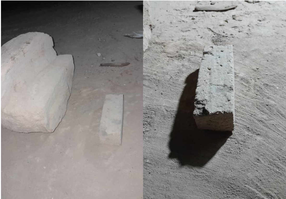
Fig (II.6) : Prélever un échantillon approprié avec des dimensions (16cm×4cm×4cm) aux fins de l'étude.
