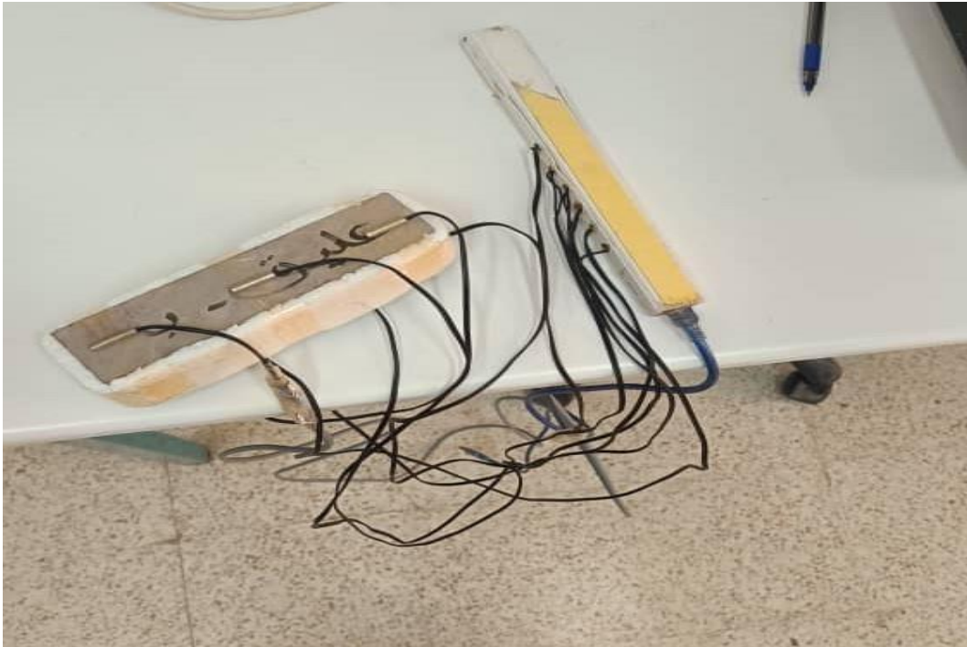
Fig (II.13) : Un échantillon avec du polystyrène et des capteurs de température.
