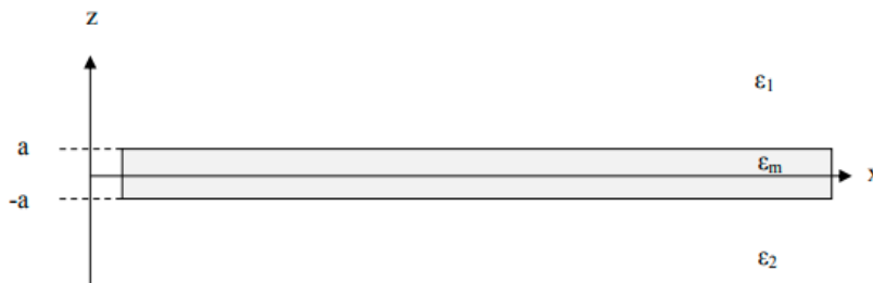
Figure I.22 : Couche de métal de faible épaisseur comprise entre deux couches infinies de diélectriques.
