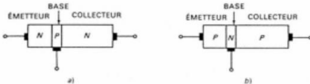
Figure (I-9) : Les trois régions de transistor : a) transistor NPN b) transistor PNP [16].
