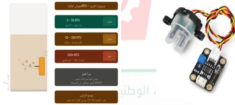
صورة لحساس رصد النفايات و الانسداد الميكانيكي + طريقة عمله
