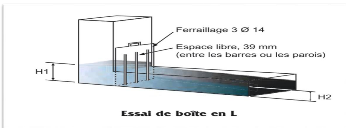
Fig.V. 6 : Essai de boit L
