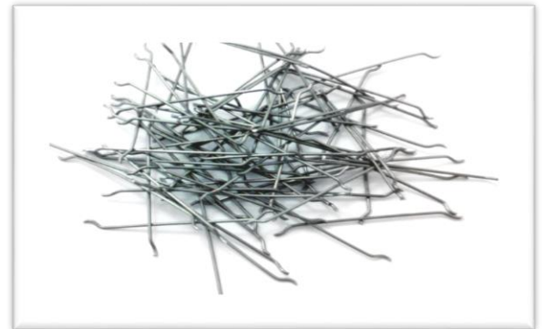
Fig.IV. 6 : Fibres métalliques utilisés
