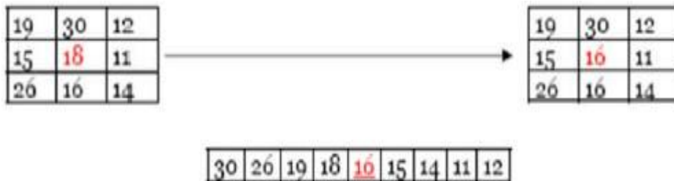
Figure I-13: Principe du filtre médian
