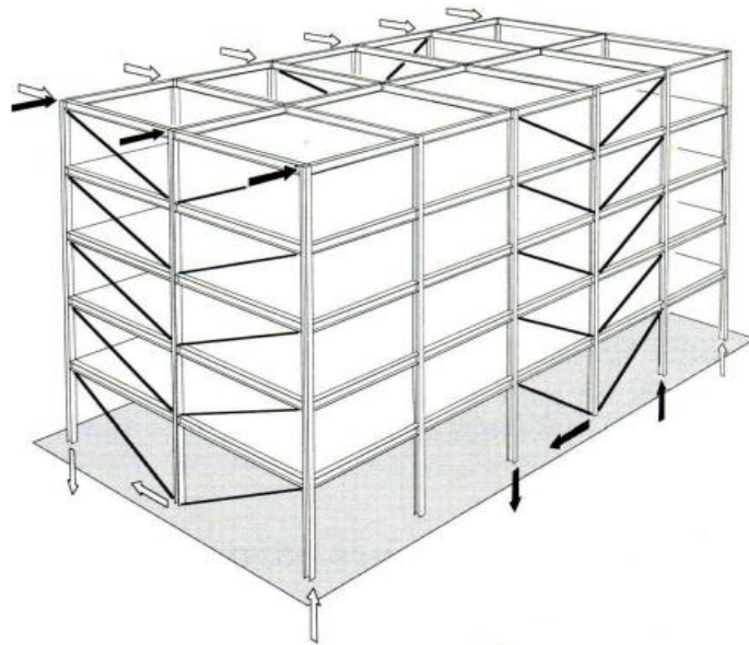
Figure 1.6 : Contreventements verticaux par des triées [7].
