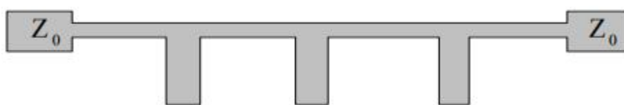
Figure II. 14 Structure d'un filtre à stub en micro-ruban.
