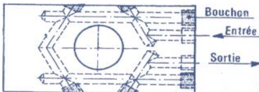
Fig. (2.13) Refroidissement d'une empreinte rectangulaire
