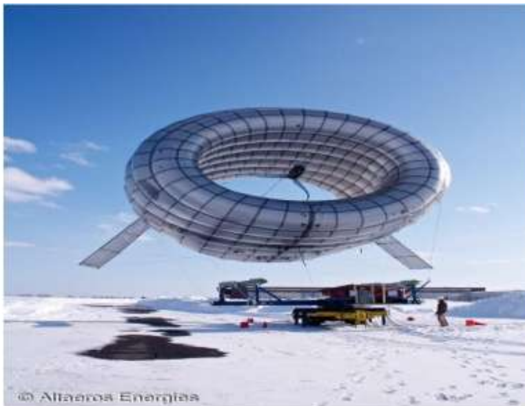
Figure( I.14) : Eolienne aéroportée Altaeros Energies en vol
