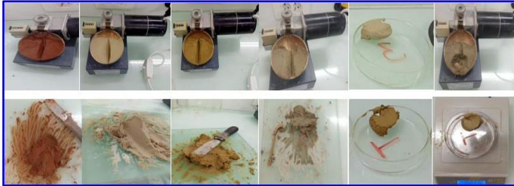
Fig.II.5. Étapes pour mesurer la limite de liquidité. (B.Issam et B.Brahim.)
