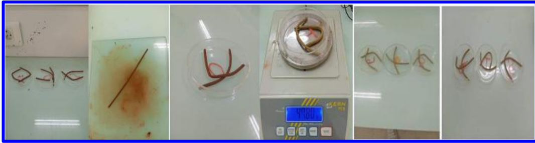
Fig.II.6. Étapes pour mesurer la limite de plasticite ( W_p ). (B.Issam et B.Brahim.)
