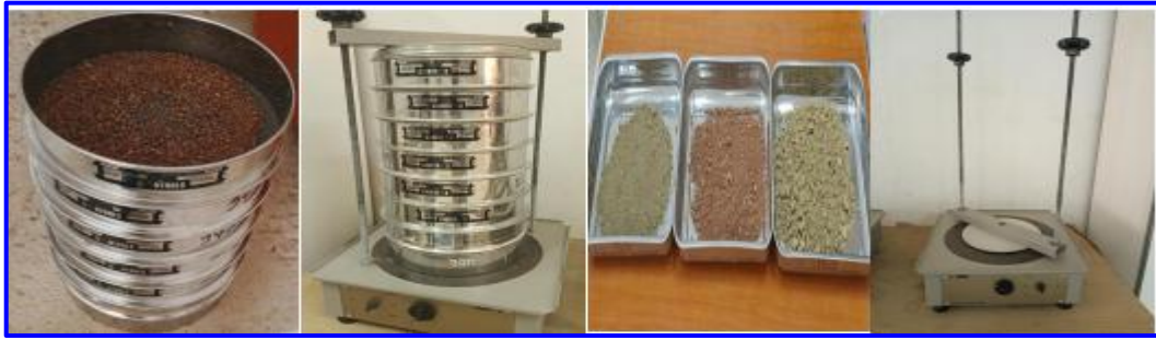
Fig.II.7.Instruments de mesure de gradient granulaire.(B.Issam et B.Brahim.)
