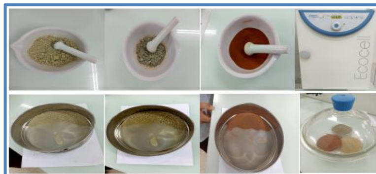
Fig.II.1. Préparation de l'échantillon argileux ( Argile Brute ). (B.Issam et B.Brahim).
