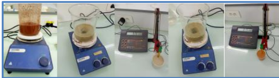
Fig.II.2..Etapas des mesures de PH. (B.Issam et B.Brahim.)
