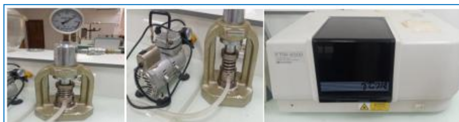
Fig.II.9. Appareil d'analyse d'infrarouge avec pastillage.(B.Issam et B.Brahim.)
