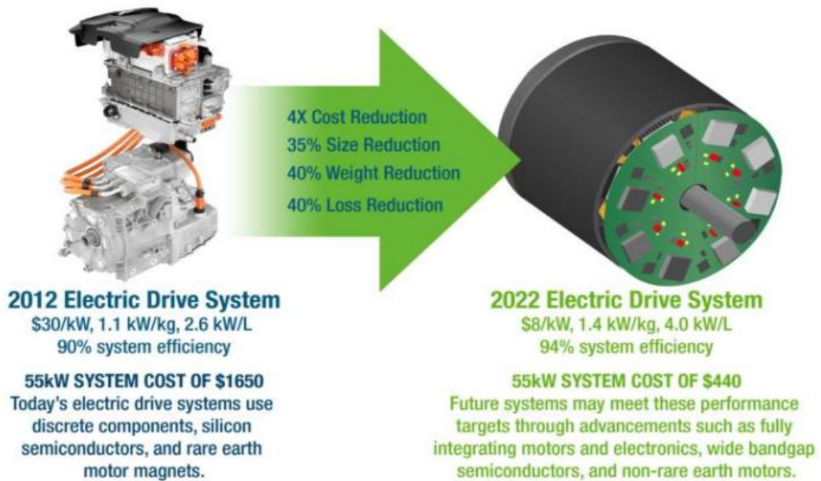
Figure I.16 : Ordres de grandeur de cout, masse, volume, puissance et rendement pour le groupe motopropulseur [34].
