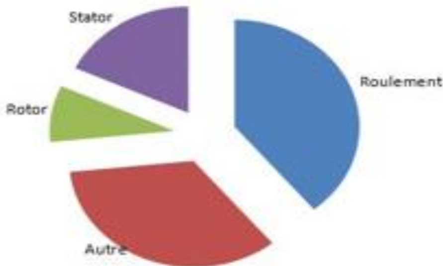
Figure I.5 : Répartition des défauts de la machine asynchrone
