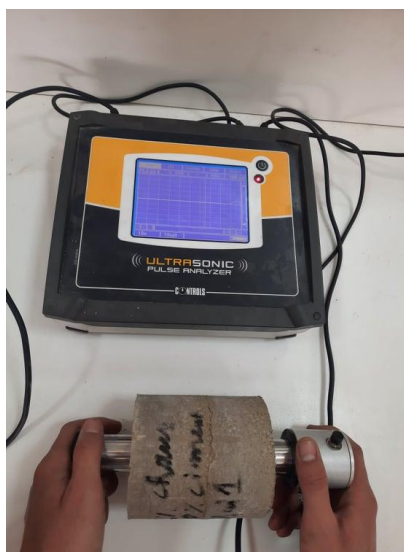
Figure IV.16 : Mesure aux ultrasons sur un échantillon de Proctor
