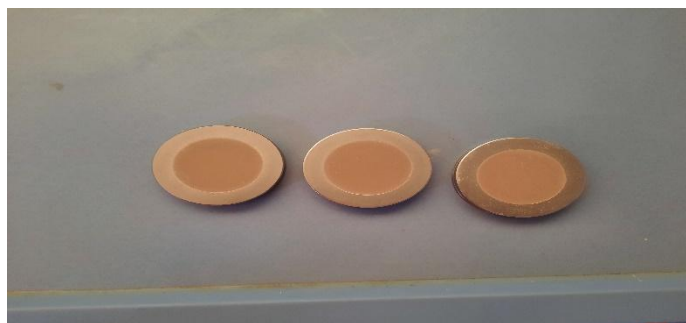
Figure IV.2 : Les pastilles d'échantillon pour le DRX
