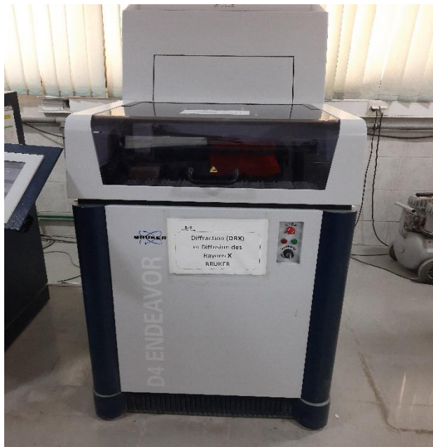
Figure IV.1 : L'appareil de DRX (à niveau de labo de Lafarge)
