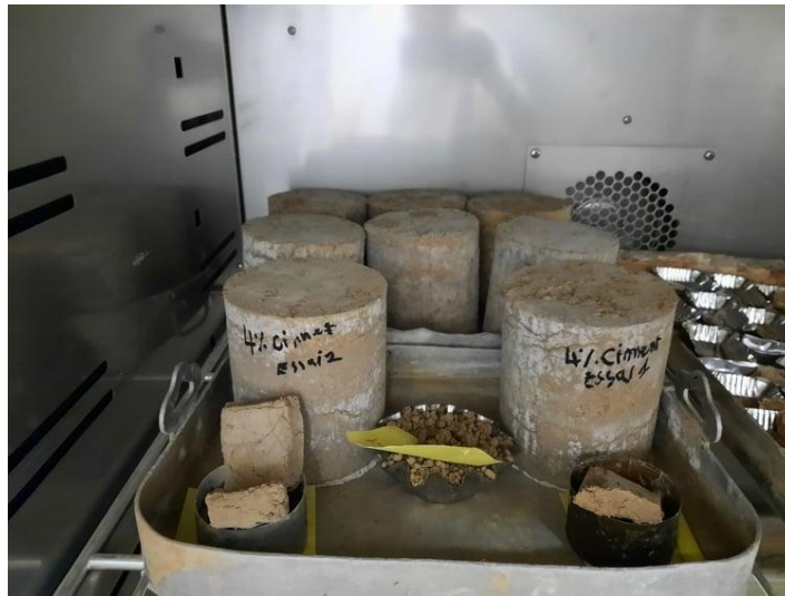
Figure IV.12 : Eprouvettes des essais Proctor Normal
