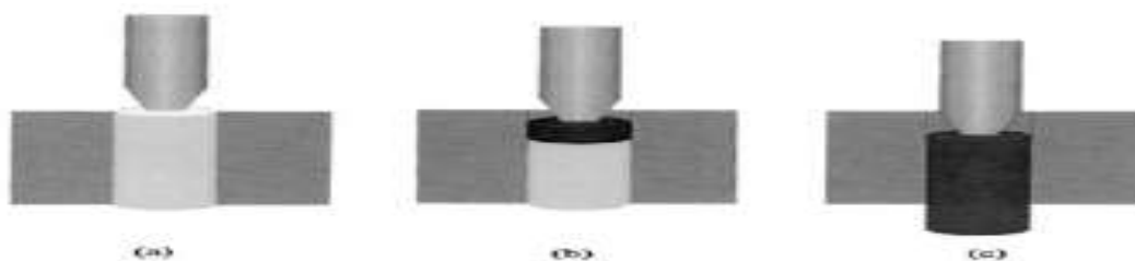
Figure III.19 : Schéma de l'essai de micro-indentation avec trois phases : (a) pas de décollement (b) décollement progressif (c) décollement total [39]
