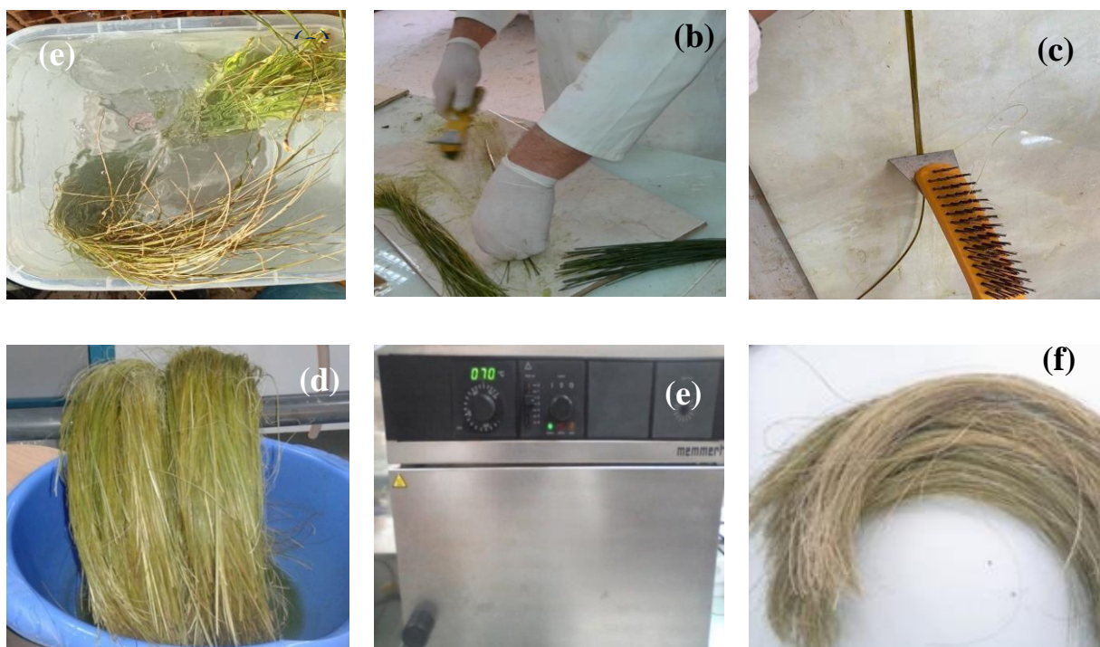
Fig.III.6 Différentes étapes de la méthode d'extraction de la fibre d'alfa :(a) les feuilles plongées dans l'eau ;(b) et (c) brossage les tiges ; (d) fibres séchées à l'air ; (e) étuvage des fibres ; (f) fibres finales obtenues.
