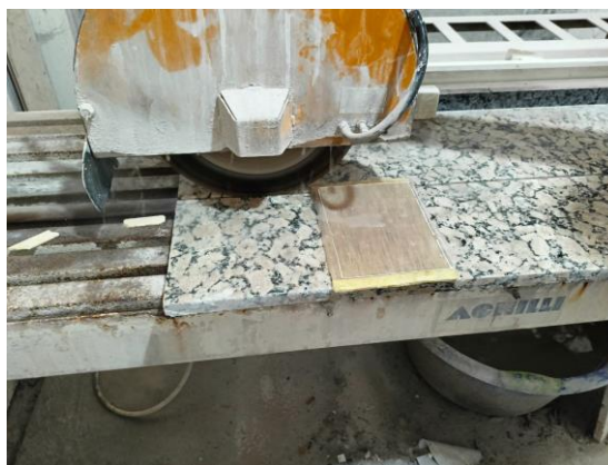
Fig.III.8 Tronçonneuse à disque utilisée pour la découpe des bio-composites
