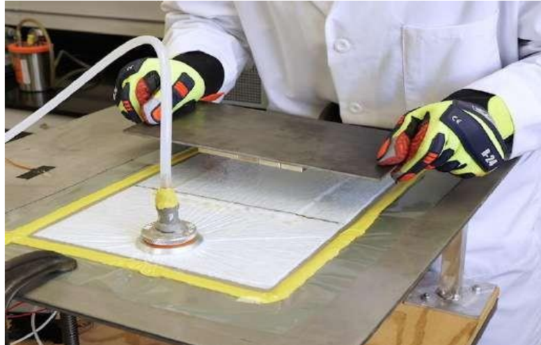
Fig.I. 25 Moulage sous vide.
