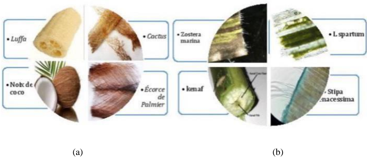
Fig.II. 14 Représentation de la distribution des fibres :(a) distribution aléatoire (b) distribution parallèle
