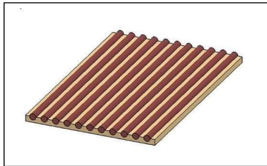
Fig.I. 13 Monocouche UD (pli unidirectionnel)
