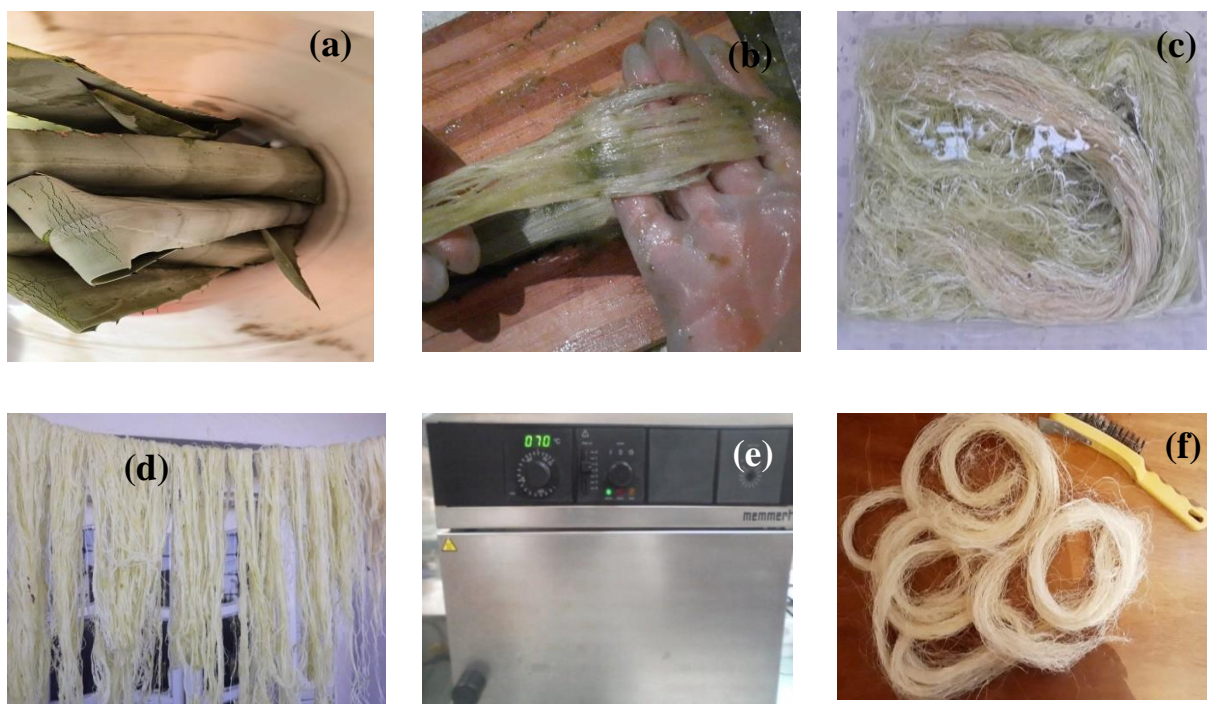
Fig.III.5 Différentes étapes de la méthode d'extraction de la fibre d'agave :a) Feuilles plongées dans l'eau ;b) biodégradation des fibres ; c) Fibres lavées à l'eau ; d) fibres séchées à l'air ; e) étuvage des fibres ; f) fibres obtenues.
