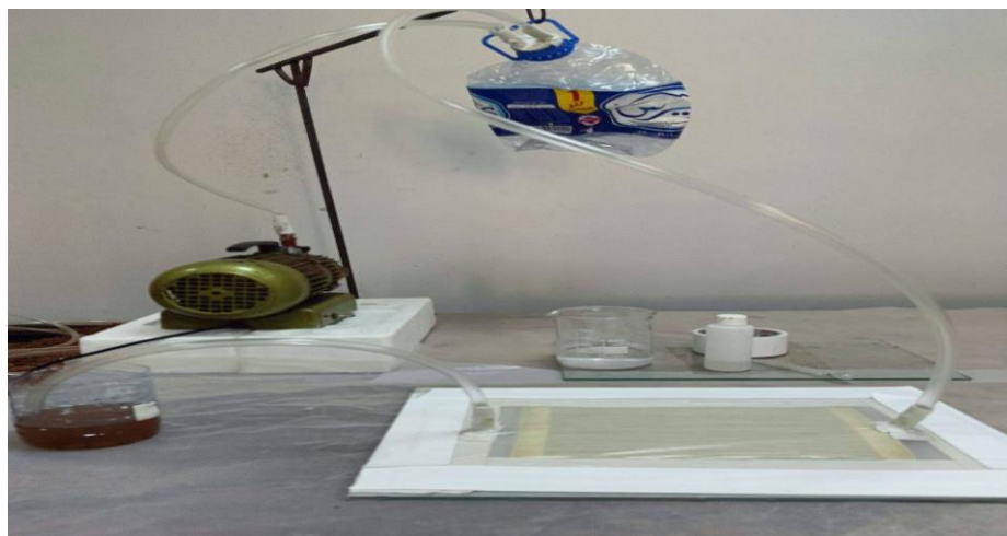
Fig.III.7 Dispositif du moulage sous vide.
