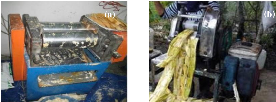
Fig.II. 15 Différente machines : (a) machine de laminage ; (b) machine de décortication
