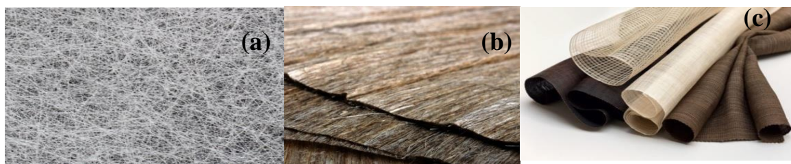
Fig.I.11 Différentes architectures des renforts de composites : (a) mats de verre, (b) tissu unidirectionnel (UD), (c) tissu bidirectionnel
