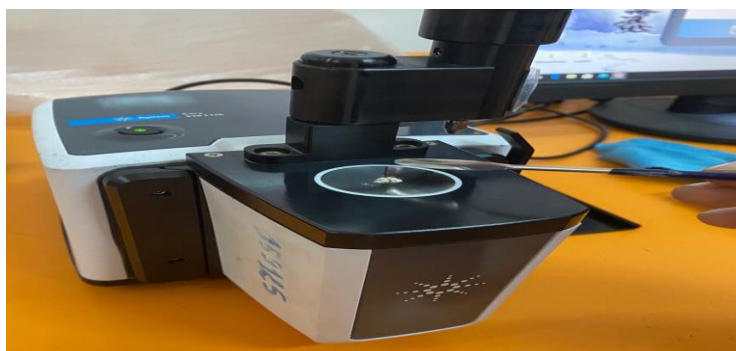
Fig.IV.1 Présentation globale du modèle ATR-FTIR Perkin Elmer Spectrum 100.
